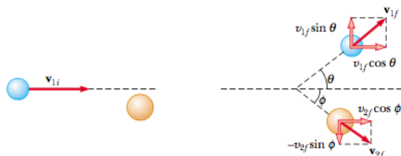
Σχήμα 4.1: Κρούση μεταξύ δύο σωμάτων στο επίπεδο. (Από [3].)
